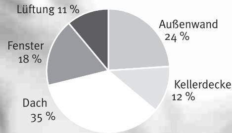
Die meiste Wärme geht über das Dach und die Außenwand verloren. Sie sollten also möglichst bei diesen Bauteilen mit einer Sanierung ansetzen. Aber auch durch die Sanierung der anderen Bauteile kann der Heizenergieverbrauch nachhaltig gesenkt werden. Durch eine ganzheitliche Sanierung kann das Gebäude Verbrauchswerte eines heutigen Niedrigenergiehauses erreichen.
