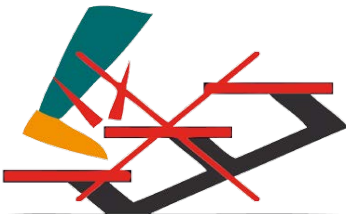
Ungünstige Stufenprofile mit hoher Sturzgefahr. Ein geschlossenes Stufenprofil reduziert die Sturzgefahr.
