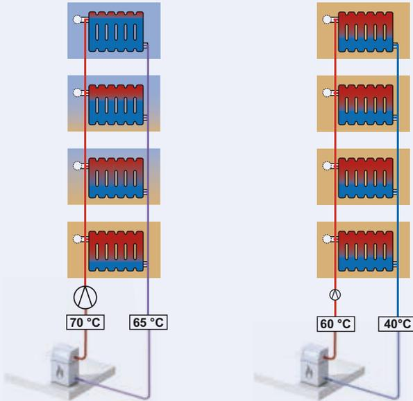
Der hydraulische Abgleich der Heizungsanlage ist die Klammer um die gesamte Heizungsoptimierung. Er sorgt dafür, dass alle Komponenten des Heizungssystems bestmöglich aufeinander abgestimmt sind, das gesamte Gebäude optimal mit Wärme versorgt wird und ein kostengünstiger und dauerhafter Betrieb der Heizung gewährleistet ist.
