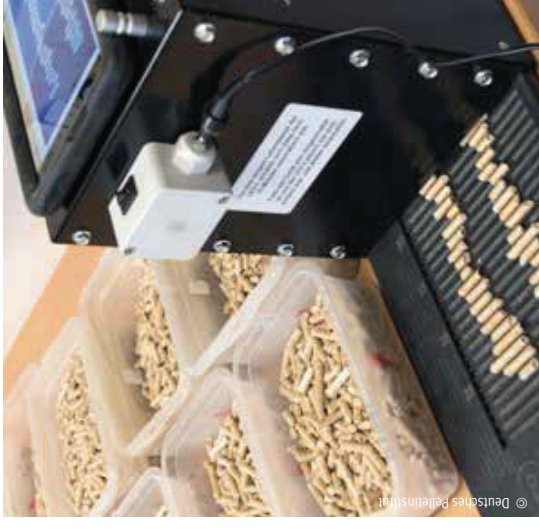
Testen der Pelletproben, um die Einhaltung der Qualitätsanforderungen des Zertifizierungsprogramms ENplus nachzuweisen.
